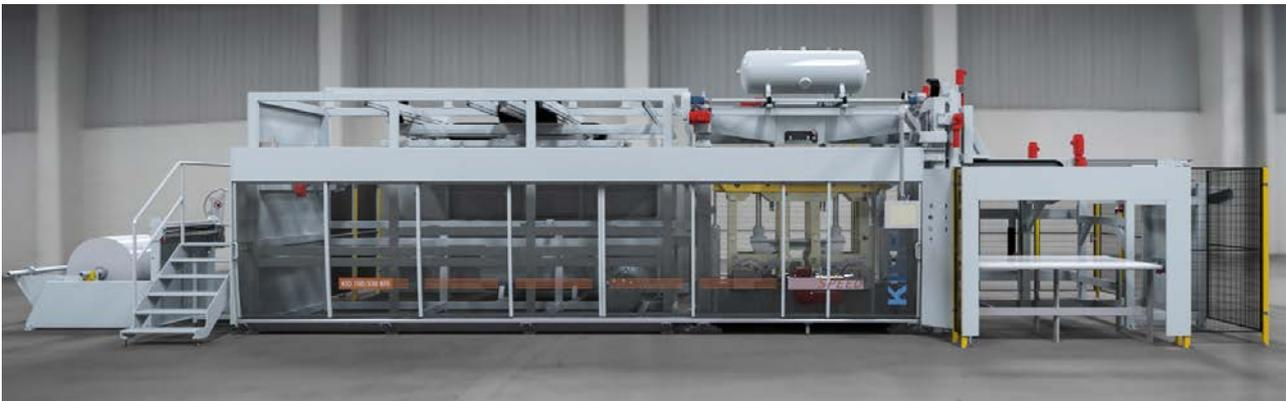
*BU: Thermoformanlage KID 100/230 BFS-R mit Form/Stanzwerkzeug, für Kühlschrankschranktüren-Innenverkleidungen*
