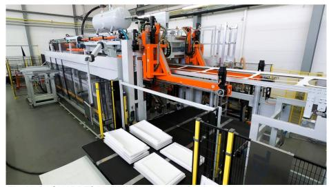
The Kiefel SHARPFORMER KID door-liner for the Appliance industry, can now produce up to 1,200 pcs/hour with a high performance multi cavity tool. © KIEFEL GmbH 凯孚尔应用于家电行业的KID-BFS模内切门衬机器,在高性能多穴模具的状态下,现在生产速度可高达每小时1200件。
